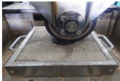
写真-2 簡易ポットホール走行試験状況
