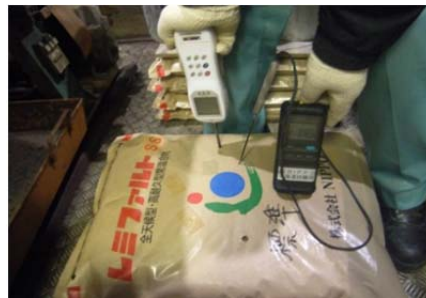
写真-1 貫入抵抗試験状況
