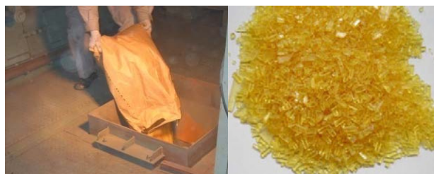
写真-3.1 HS添加材投入および形状
