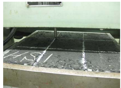
写真-4.2 静荷重载荷試験状況
