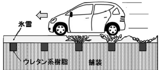
図-4 グルーピングウレタン工法の機能概念図
