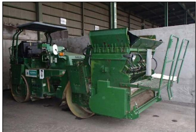
写真-2 ゴム骨材散布装置付振動ローラ
