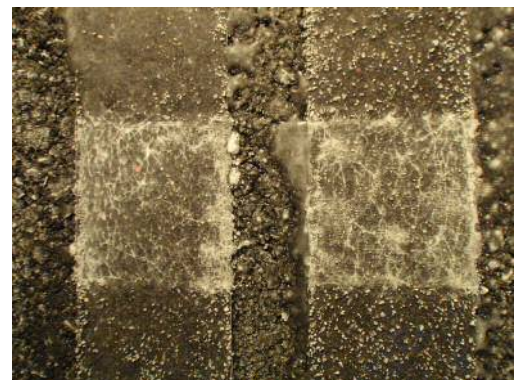
写真-3 WT試験機による氷盤破碎試験結果
