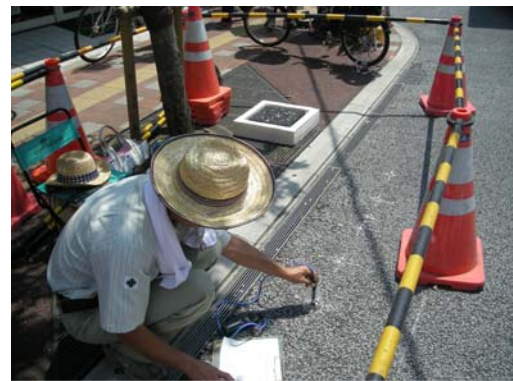
写真-2 現地調査状況例 (路面温度測定)
