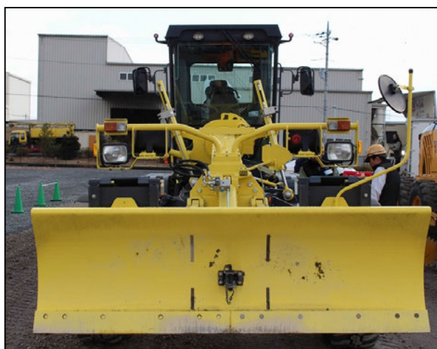
(写真-3 前方ブレード)
